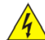
Tensione elettrica pericolosa
